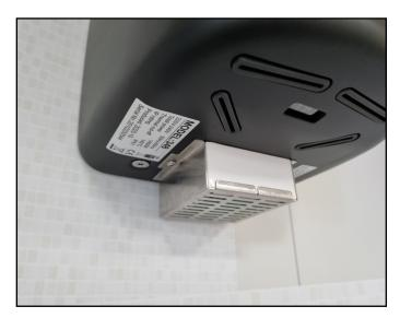
4. Fertig. Das Filter wurde jetzt montiert / ausgetauscht.
